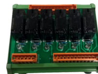
Stok Adı HIZ MODÜL KARTI (SPEED RELAY BORD)
